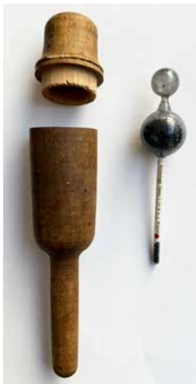
2348 MILCHWAGE, tester za ispitivanje temperature mlijeka, J. WAGNER, kraj 19. stoljeća. U originalnoj drvenoj kutiji. Dimenzije: 20,5 cm.
